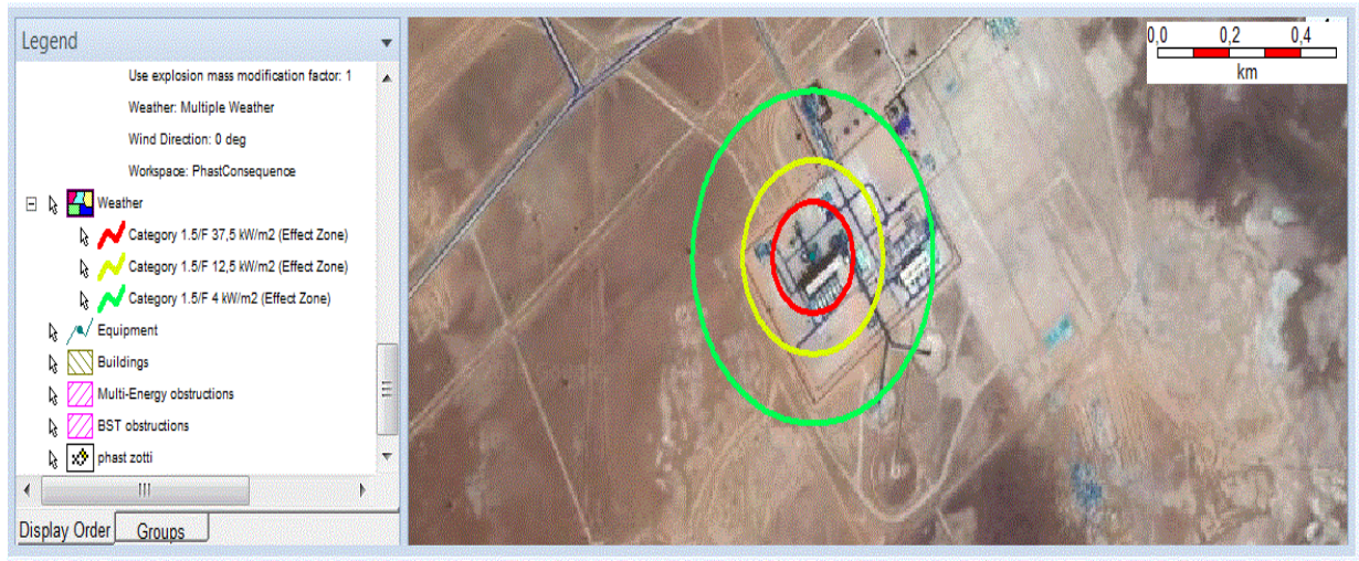
Figure 31 : Catastrophie des effets thermiques d'un feu de torche dans l'unité de stabilisation de condensat
