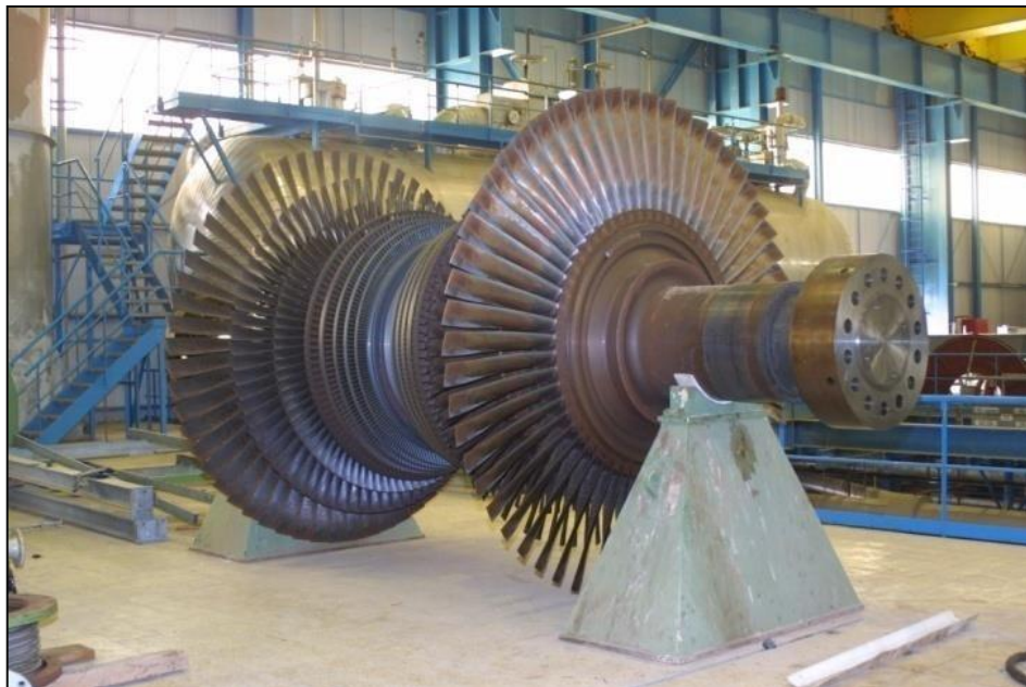
Figure (1.4) : Corps BP de Turbine à vapeur. [2]
