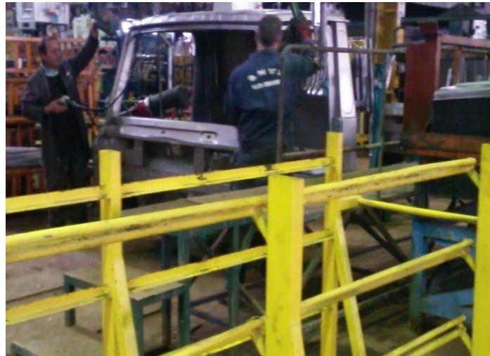
Figure II.3 : Positionnement de toit manuellement par deux ouvriers [13]
