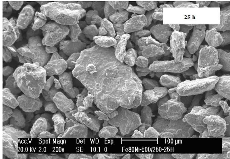
**Figure III. 16.** Micrographie des poudres  $\text{Fe}_{80}\text{Ni}_{20}$  obtenues par mécanosynthèse après 25 h de broyage.
