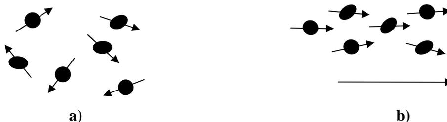
**Figure. I. 3.** Orientation des moments magnétiques dans un matériau paramagnétique: a) en absence de champ magnétique, b) en présence de champ magnétique.
