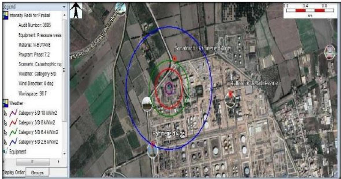
Figure II.5 : Intensité des radiations de la boule de feu.
