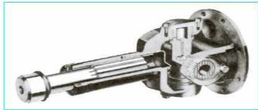
**Figure.III.12** Joint de cardan coulissant avec ses cannelures
