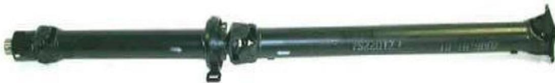
**Figure.III.10** arbre de transmission à Palier intermédiaire
