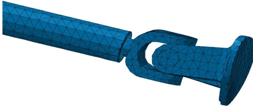
**Figure V.2** : Déformation de l'arbre de transmission au niveau des brides
