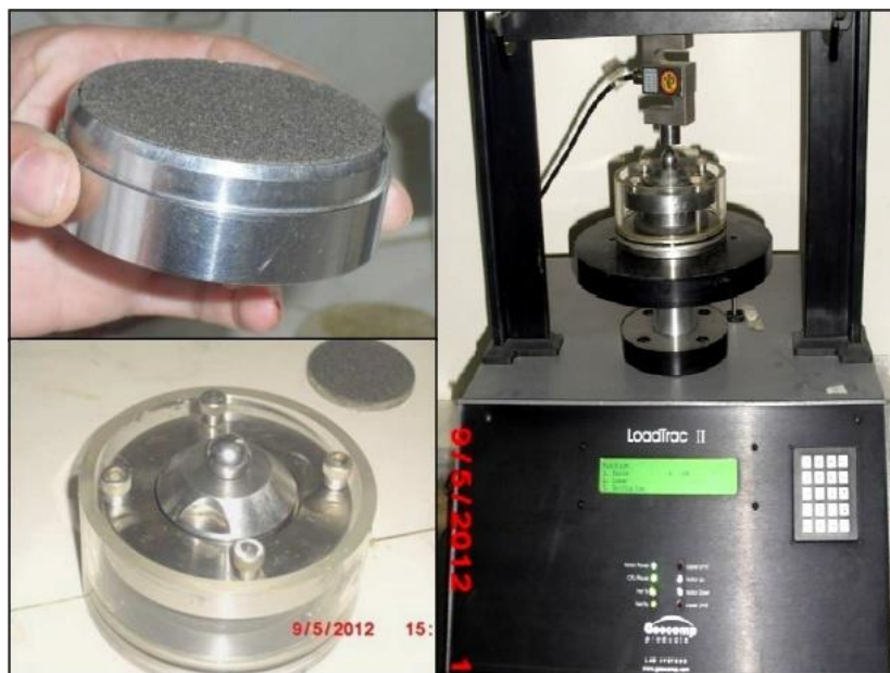
Figure 3.20 : Dispositif utilisé pour l'essai œdométrique.
