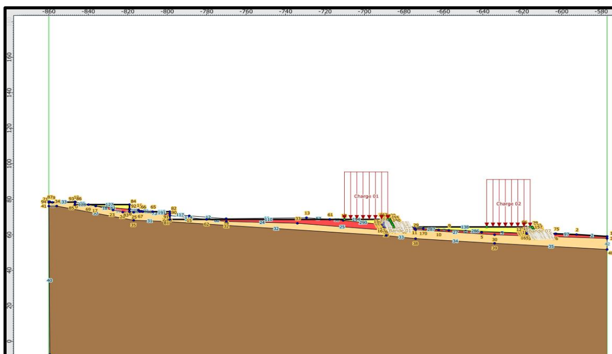
Figure 5.4:Photo illustrative du talus (01) de la coupe (01) des deux massifs en remblai.
