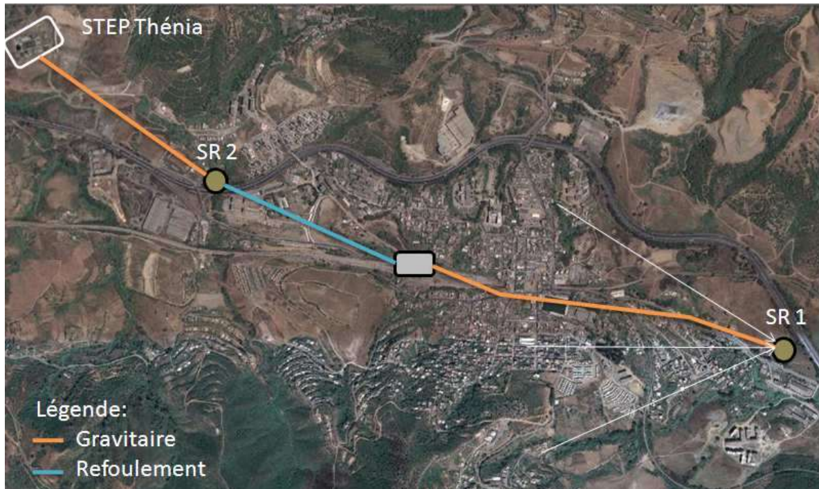
Figure II-2: Schéma représentant le système d'assainissement d'alimentation de la STEP de Thénia [20].
