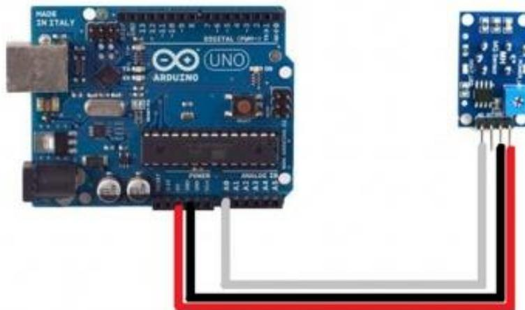
Figure 8 : Branchement du MQ-5 avec Arduino
