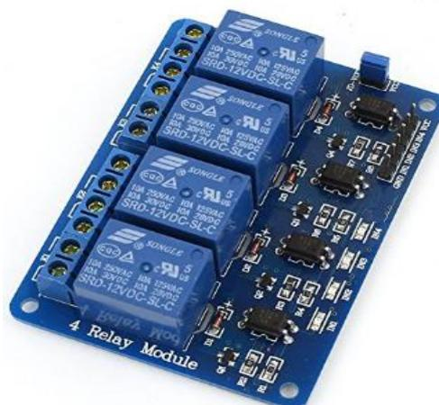
Figure 10 : Module relais à 4 canaux
