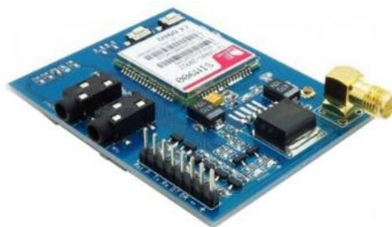
Figure 17 : Module GSM SIM900
