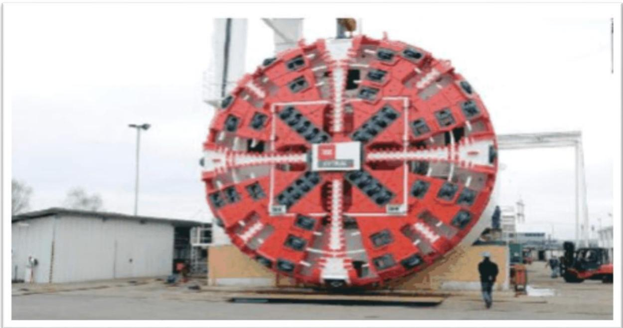
Fig.II.13. Roue de coup du tunnelier à pression de boue
