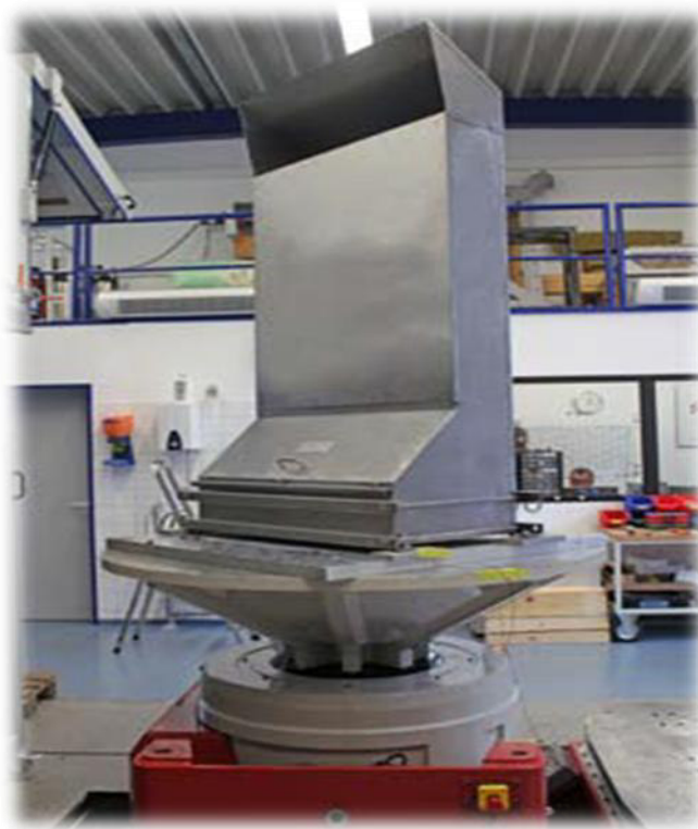
Figure 1.4 : le recombineur catalytique NIS
