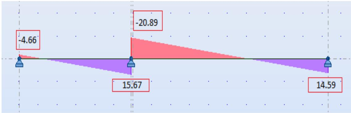
Figure III.12 : diagramme des moments et des efforts tranchants à l'ELU
