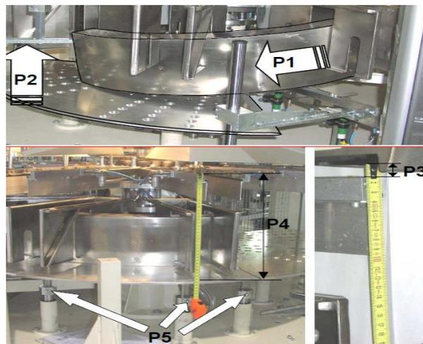
**Figure V.7 :** Remontage de la protection
