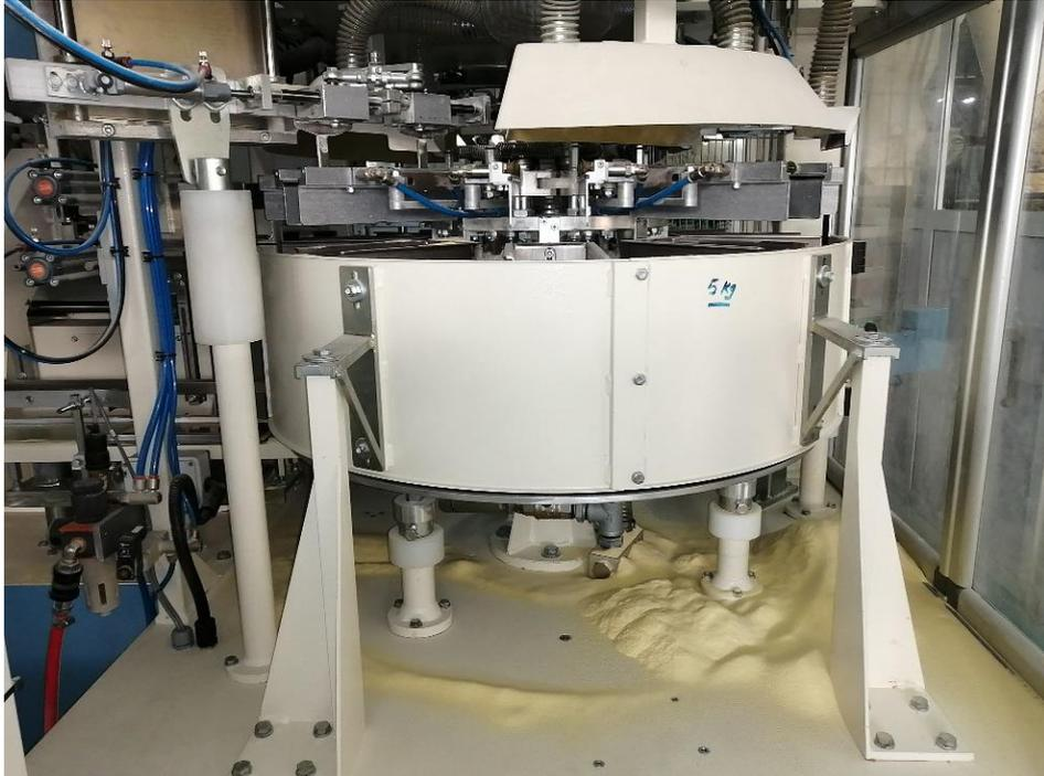
Figure IV.8 : Tourniquet de remplissage
