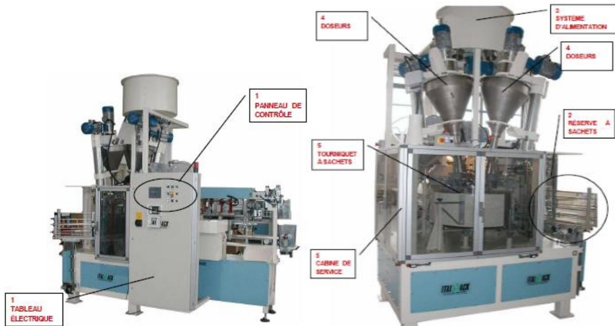
Figure IV.2 : Face avant et côté gauche de la machine
