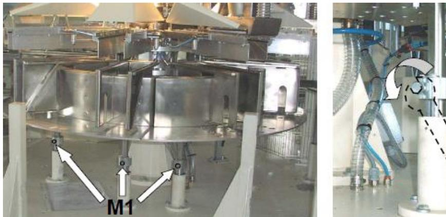
**Figure V.4 :** Dévissant les vis de serrage (M1)
