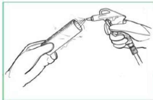
**Figure V.21** : Nettoyage des filtres
