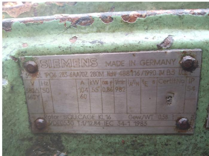
FIGURE 1.6 – Moteur asynchrone du concasseur
