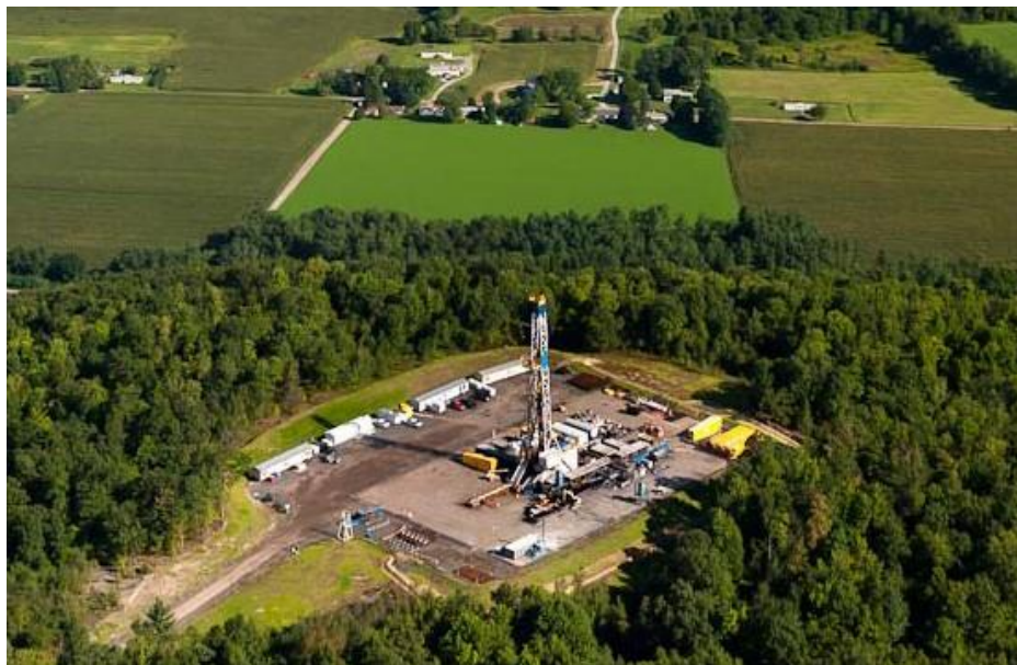
Figure IV-2 : Occupation du terrain pendant la phase d'exploration
