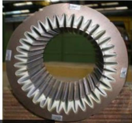
Figure (II.8) : Stator sans bobinage
