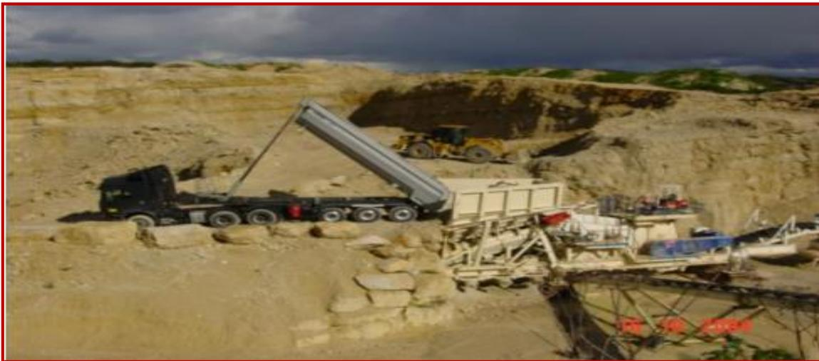
**Figure (I.7):** Déchargement du calcaire dans le concasseur.
