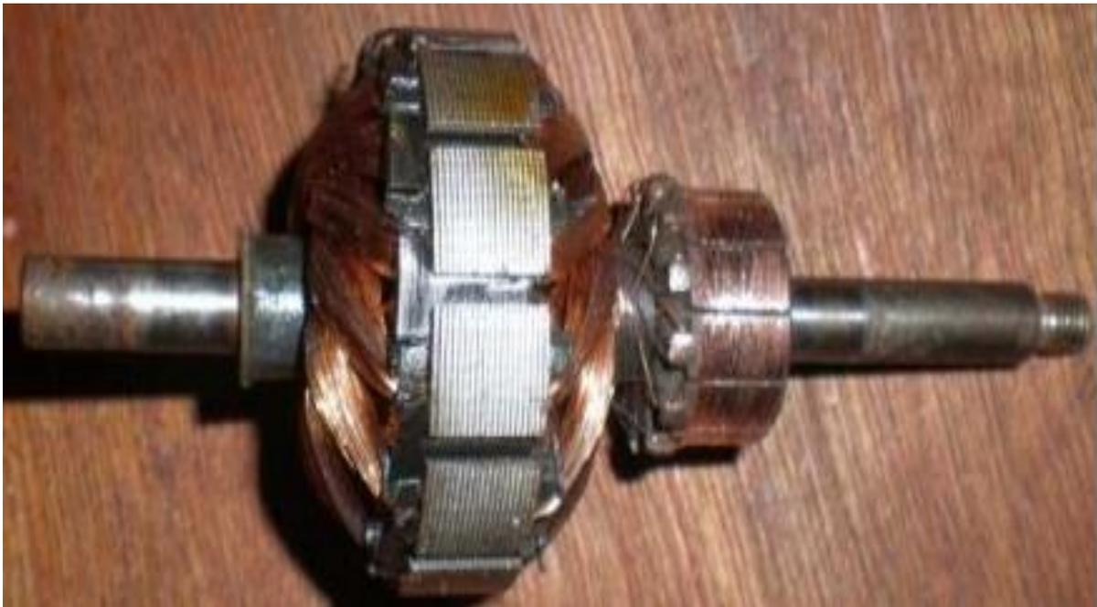
Figure (II.12) : Rotor à bagues.
