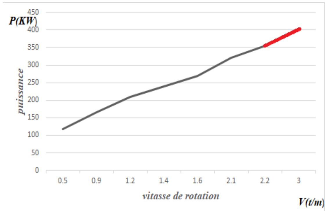
**Figure(III.18)** : La puissance de four in fonction de vitesse de rotation.
