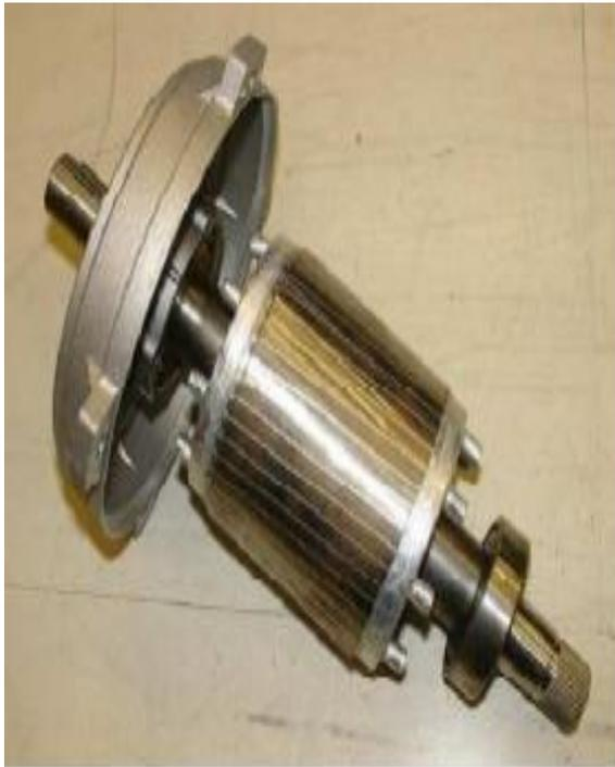
**Figure (II.9) :** Rotor à simple cage
