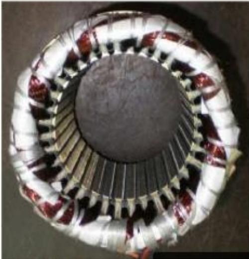
Figure (II.7) : Stator Avec bobinage
