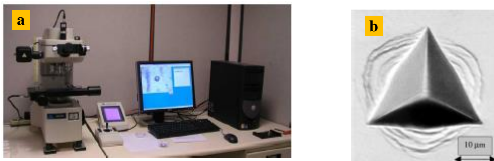
Fig. III.2: Essai de microdureté a - dispositif pour essai de microdureté piloté par ordinateur, avec acquisition d'image, b - trace d'un indenteur (Berkovitch)
