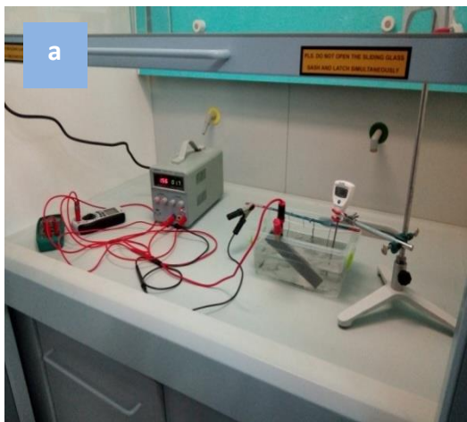
Fig. III.1 Procédé d'anodisation : a -Anodisation, b - Colmatage.
