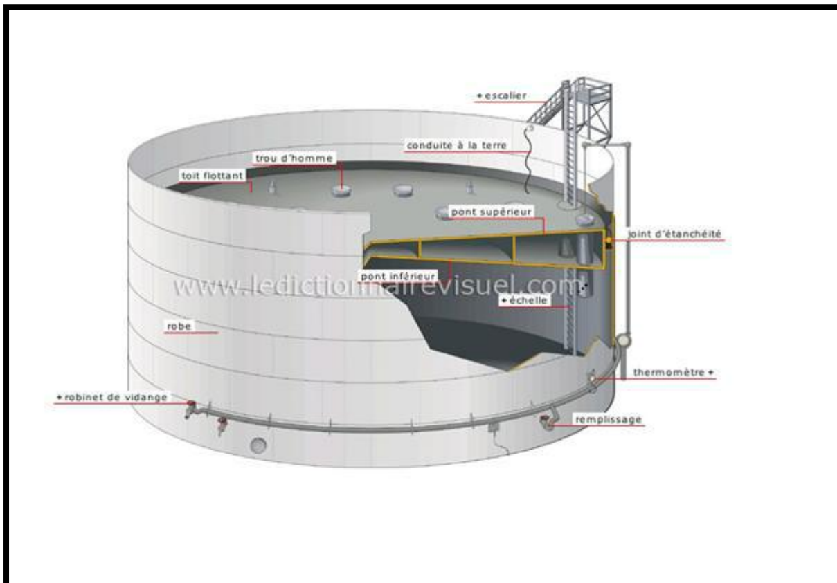
Figure I.7 : Réservoir à toit flottant
