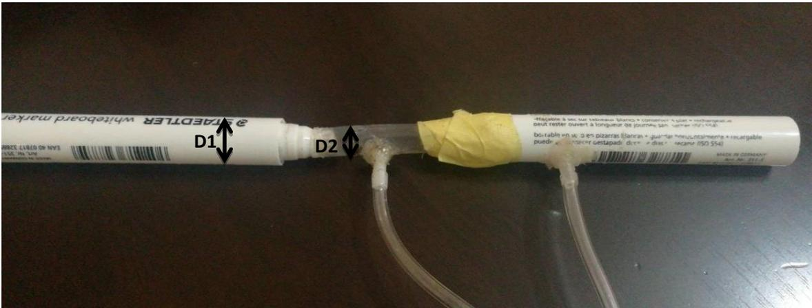
Figure III.1 : Tube venturi fabriqué
