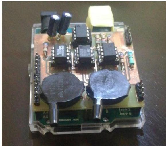
Figure III.4 : Circuit final réalisé
