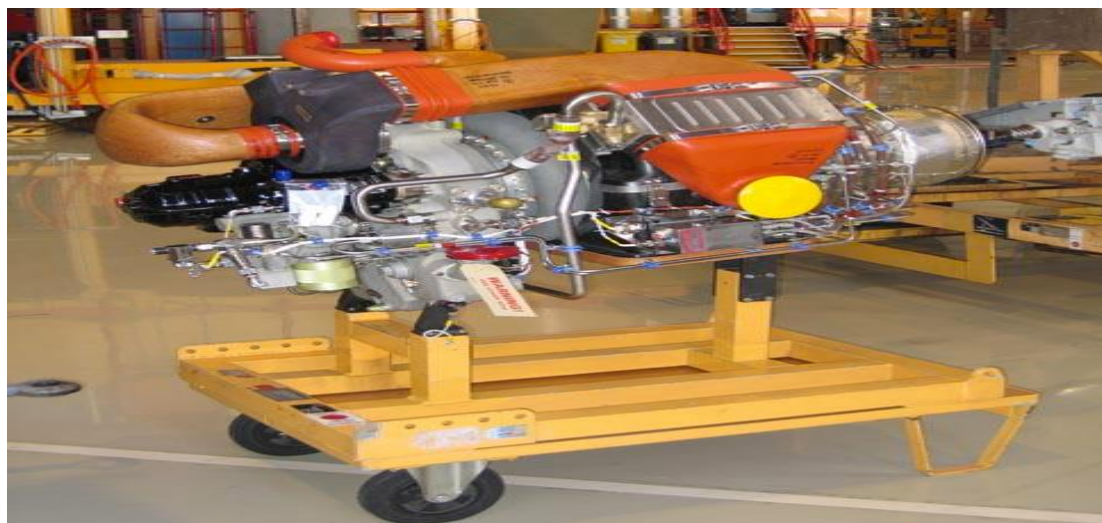
Figure I. 7: moteur APU APIC A320
