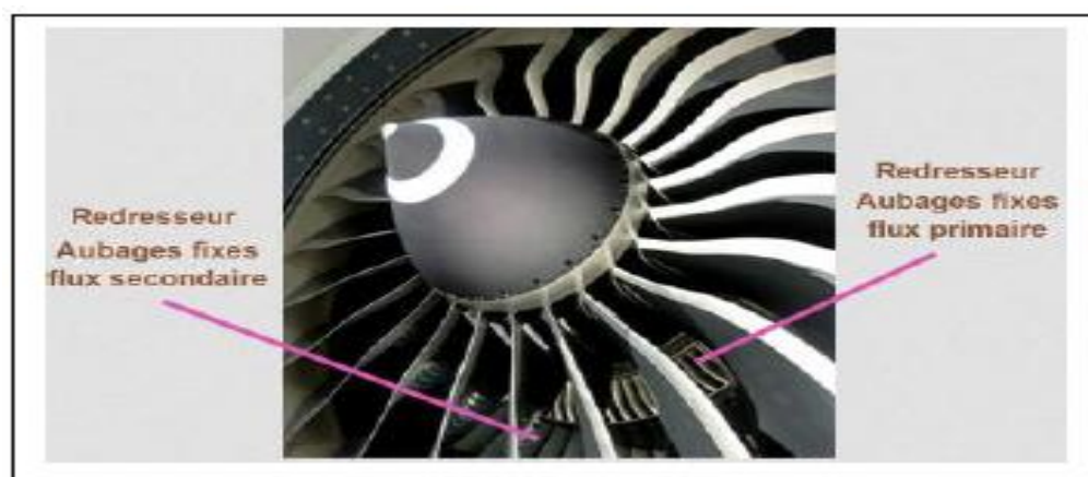
Figure II. 5 : La soufflante du GE90
