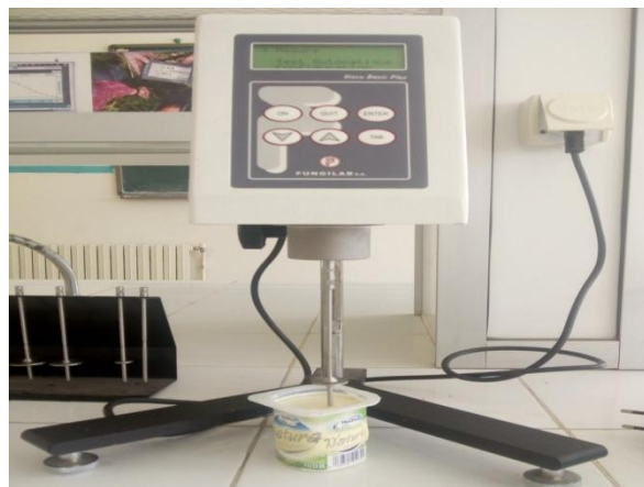
Mesure de la viscosité du yaourt
