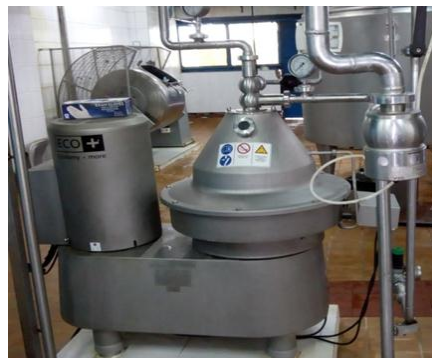
L'appareil d'écumage (photo originale)
