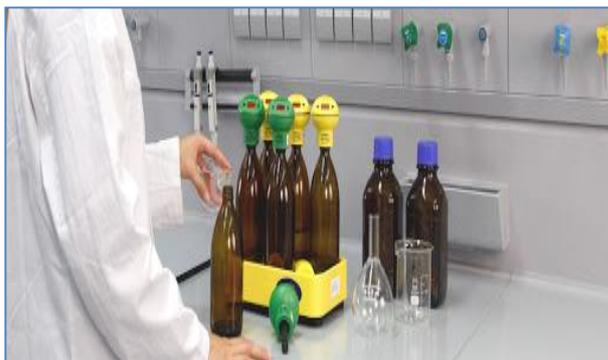
**Figure 16** : Dispositif de mesure de la DBO<sub>5</sub>.
