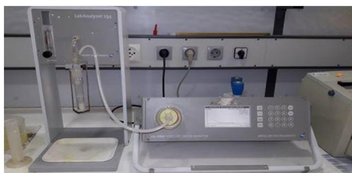
**Figure 13 :** Appareil de la Spectroscopie d'Absorption Atomique sans Flamme (SAA sans Flamme).
