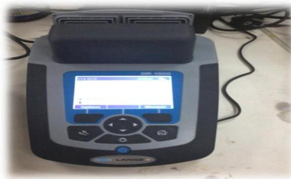
**Figure 15** : Spectrophotomètre (type DR1900).
