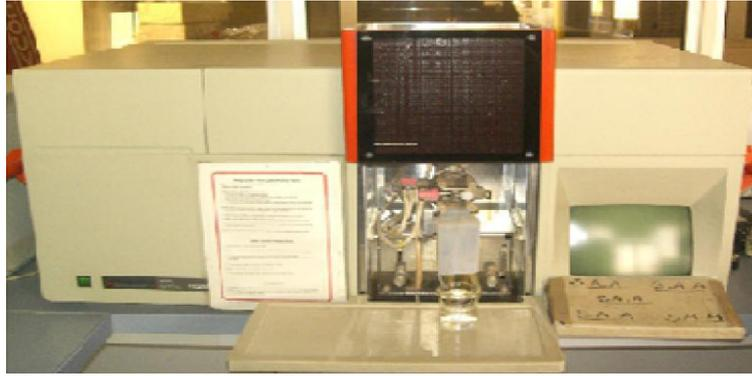
**Figure 11** : Appareil de la Spectroscopie d'Absorption Atomique (SAA).
