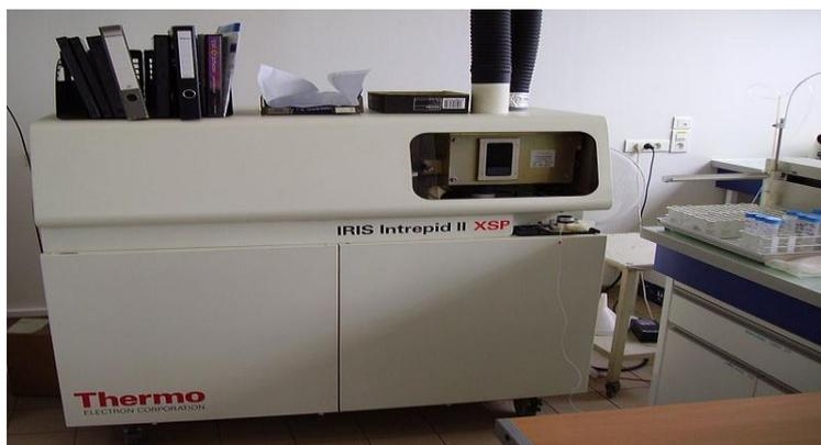
**Figure 12 :** Appareil Spectrométrie de Masse associée à un Plasma d'argon à Couplage Inductif (ICP-MS).
