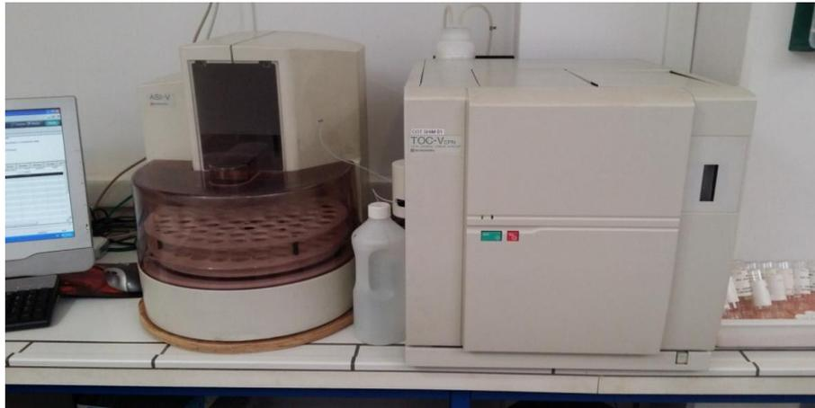
**Figure 14** : Dispositif de mesure du COT[23].
