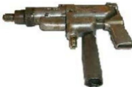
**Figure (3.9) :** Outil de nettoyage mécanique.
