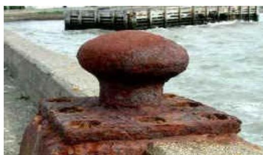
**Figure I.2 : Corrosion Généralisée**
