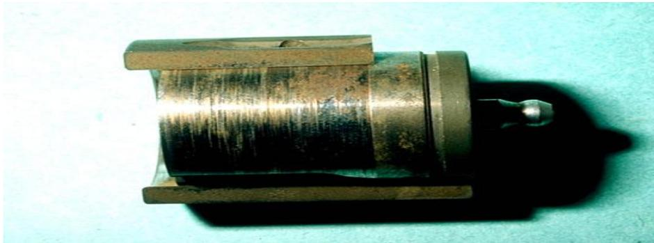
**Figure I.11** : Corrosion frottement
