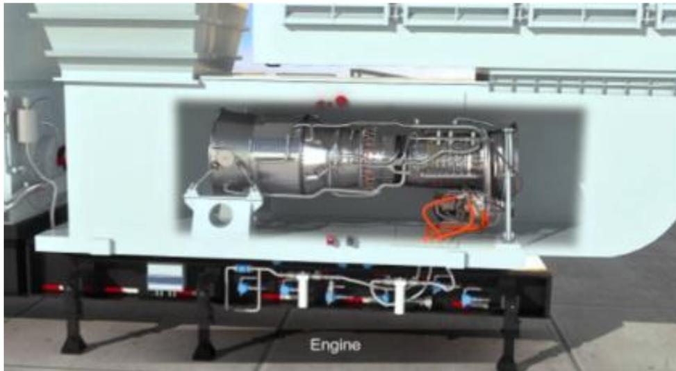
Figure I.5. Turbine à gaz LM2500+.
