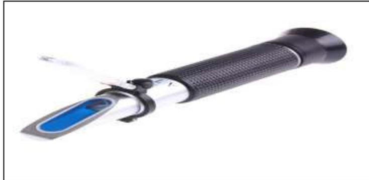
**Figure17** : Photographie du réfractomètre à main (ATC).
