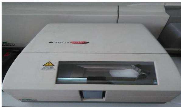
Figure N°29 : images de granulometre Type MASTERSIZER 2000
