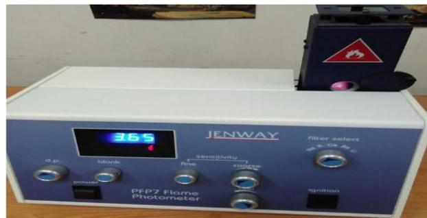
Figure N°34 : Images de Le photomètre à flamme
