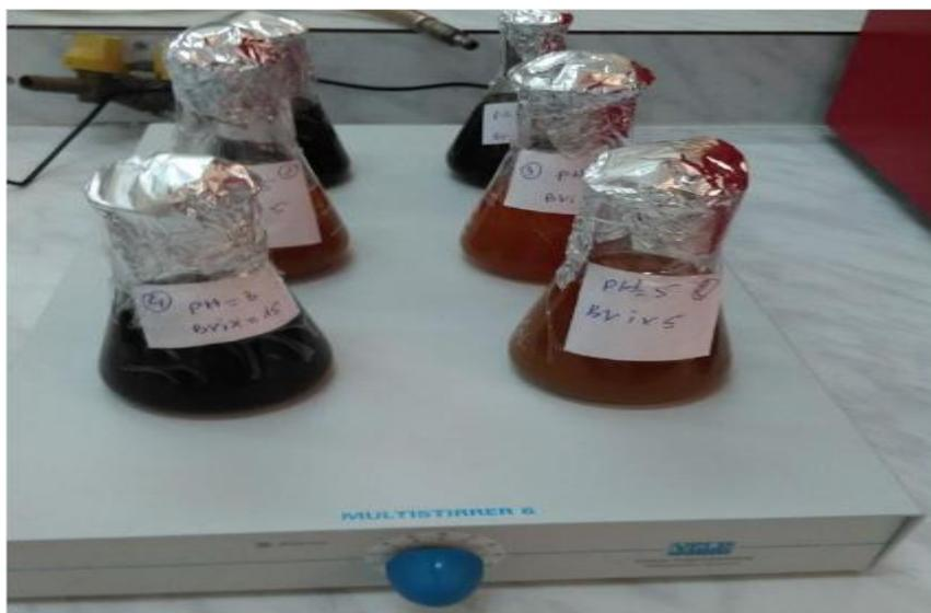
**Figure N°40:** Images de la production du bioéthanol par méthodologie des plans d'expérience
