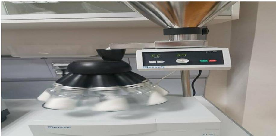
**Figure N°28 :** images de la détermination Granulométrie du sucre blanc
