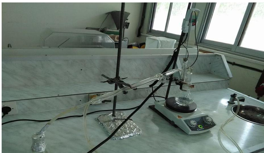
**Figure N°41 :** Image de l'hydro distillation de l'éthanol à 85 °C
