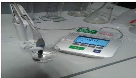
Figure N°20: Image de la mesure conductimétrique
