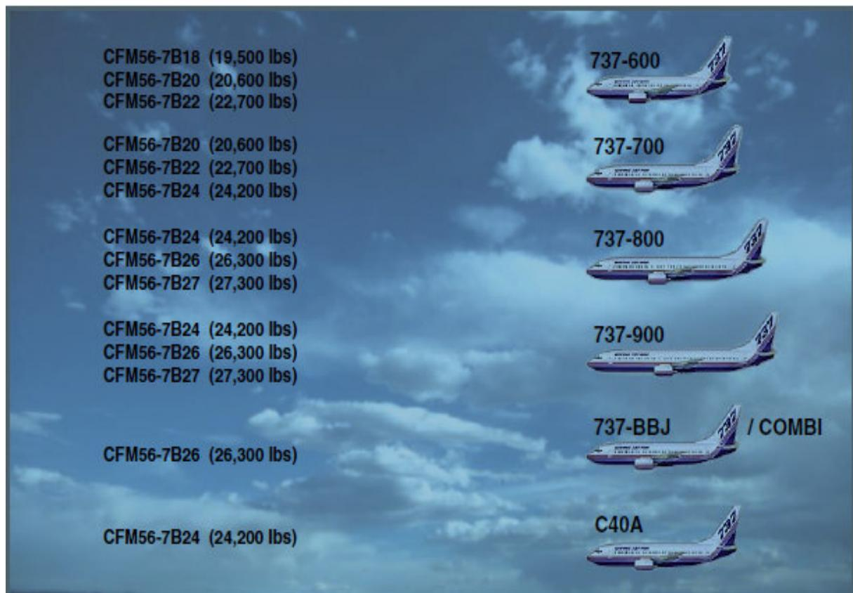
Figure 1 : distribution des moteurs CFM56-7b sur les Boeing
