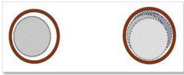
Figure 3. 10. Défauts d'excentricité statique et dynamique.
