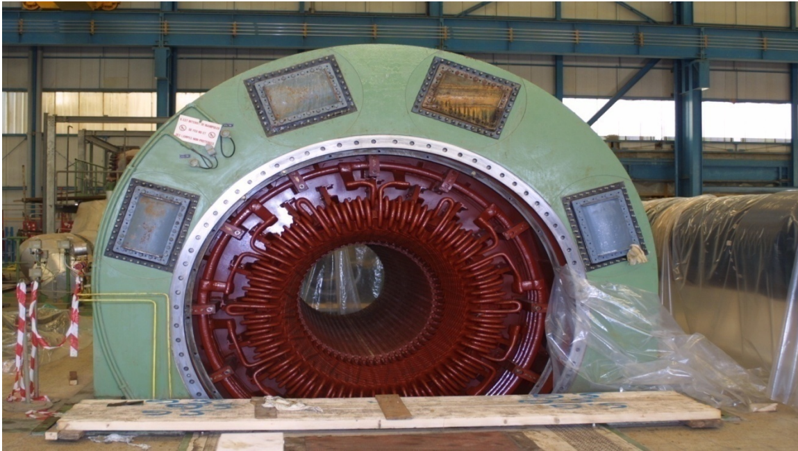
Figure 1. 7. Partie fixe de l'alternateur (l'induit)
