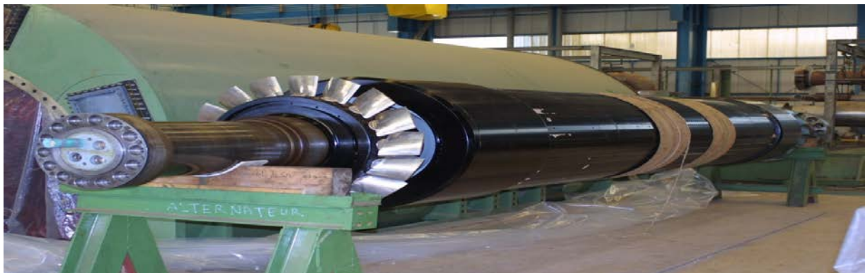
Figure 1. 6. Partie mobile de la machine (l'inducteur).
