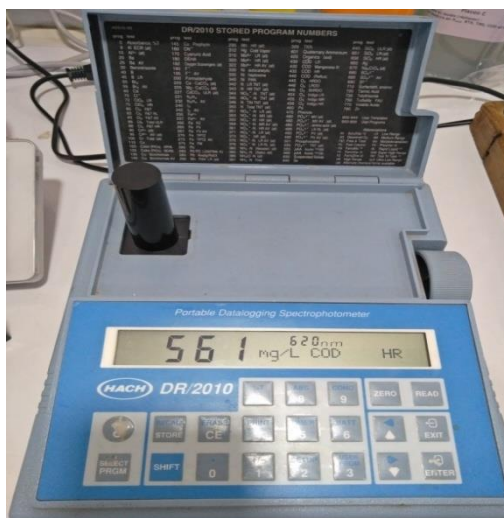
Figure IV.28: Spectrophotomètre HACH Type DR /2000.
