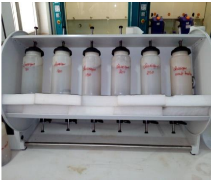
Figure IV.16 : Dispositif d'agitation Pour l'essai de lixiviation.
