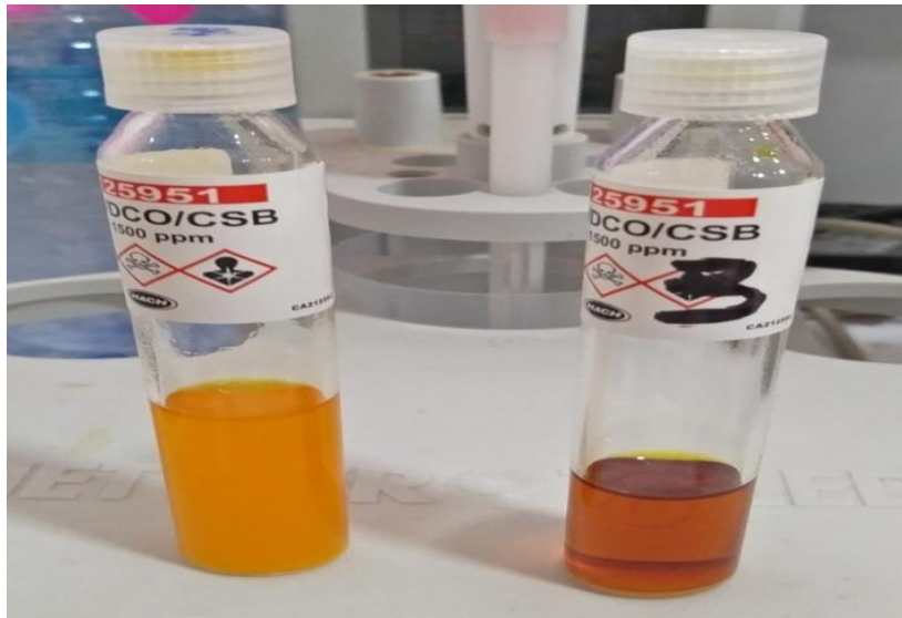
Figure IV.27 : Tubes DCO (0 à 15 000 mg /L) pour les fortes concentrations.
