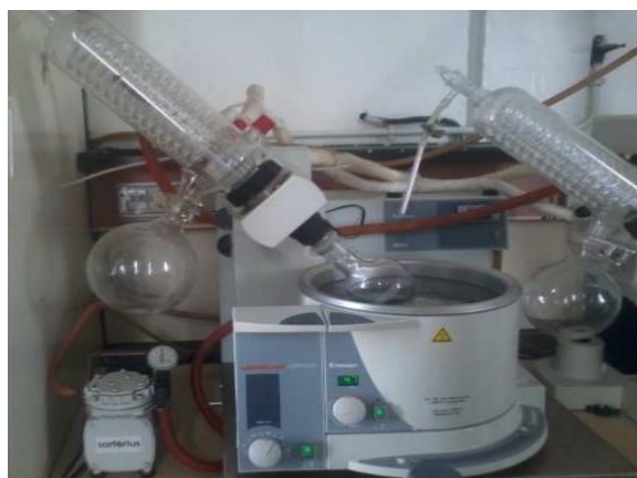
Figure IV.33 : Concentration des échantillons par rota-vap.
