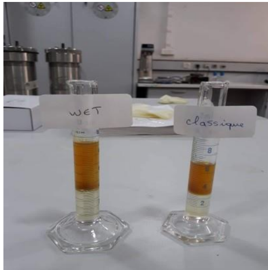
Figure IV.14 : Les éprouvettes graduées du distillat récupéré des échantillons (WET et Classique).
