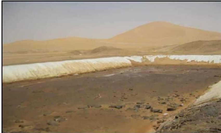
Figure I.4 : Bourbiers après une opération de forage.
