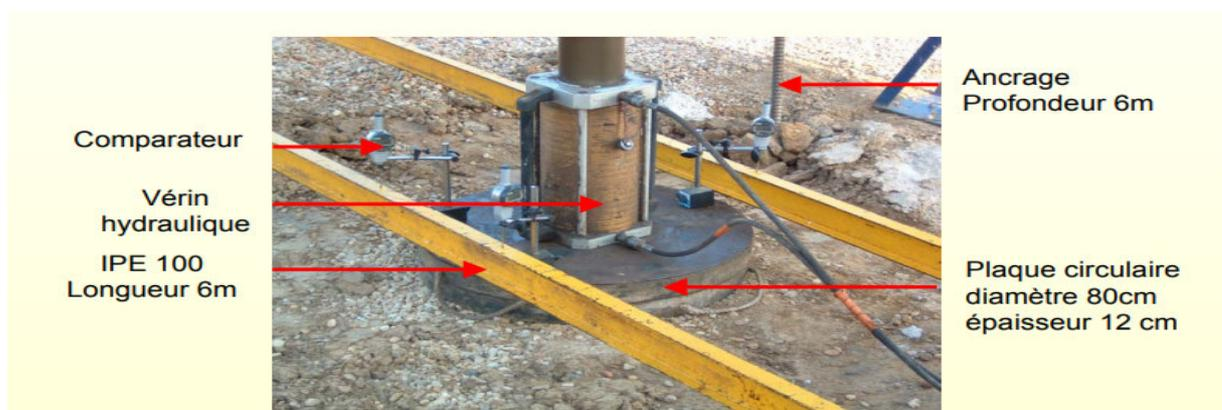
Figure VI.4 : Schéma explicatif de l'essai de chargement.
