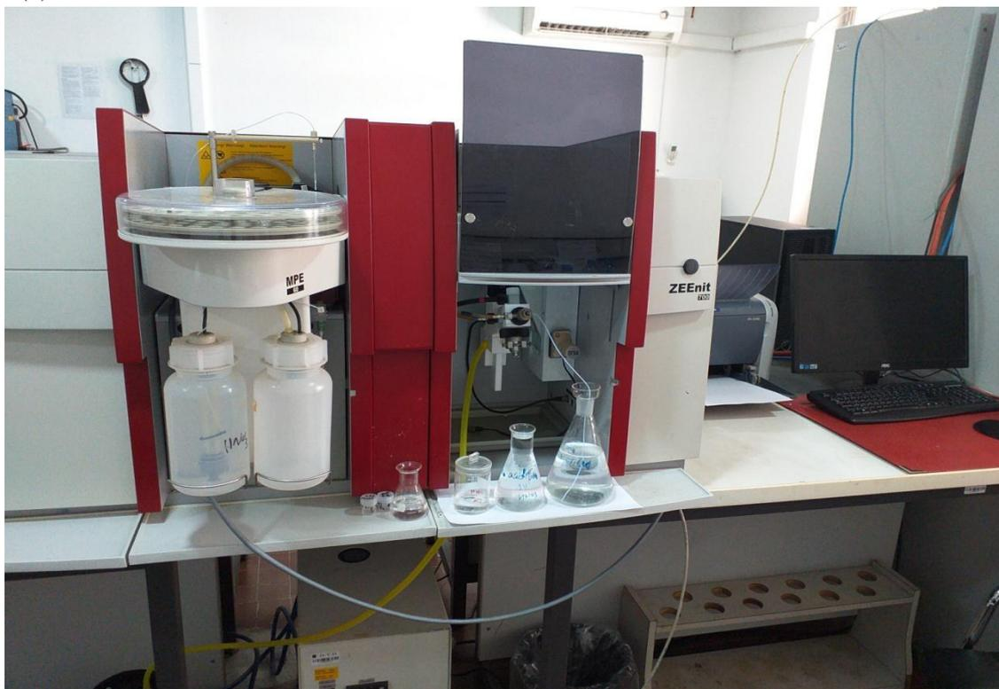
**Figure 12:** Spectrométrie d'adsorption atomique (SAA. ZEENIT700).
