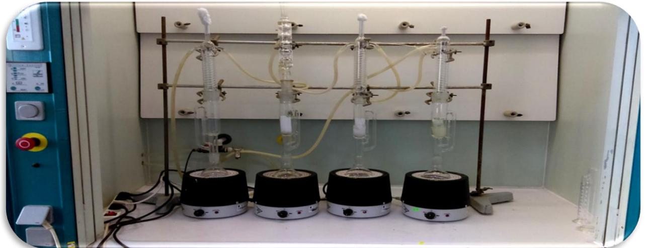
**Figure 15** : Extraction par Soxhlet.
