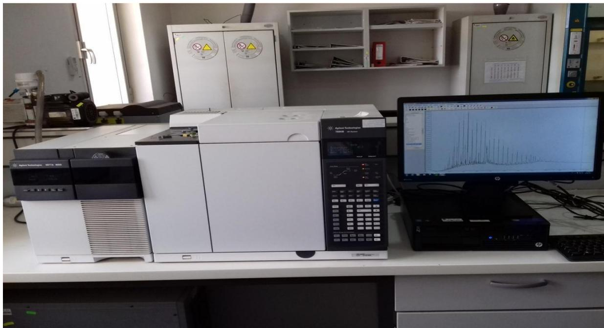
**Figure 14:** Chromatographie en phase gazeuse couplée au spectromètre de la masse
