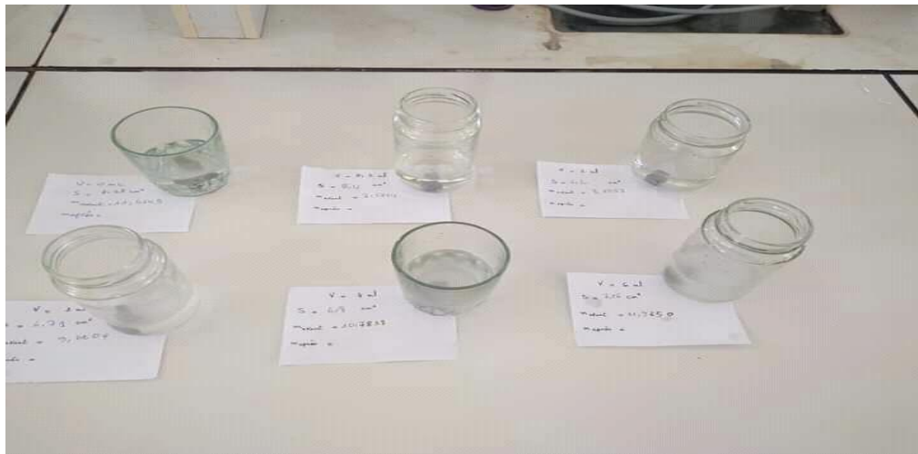
Figure II.4. Acier X60 dans HCl (1M) en présence de l'inhibiteur à différentes concentrations.
