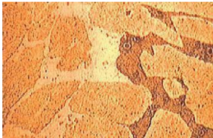
Figure I.6. Corrosion sélective d'un alliage [11].
