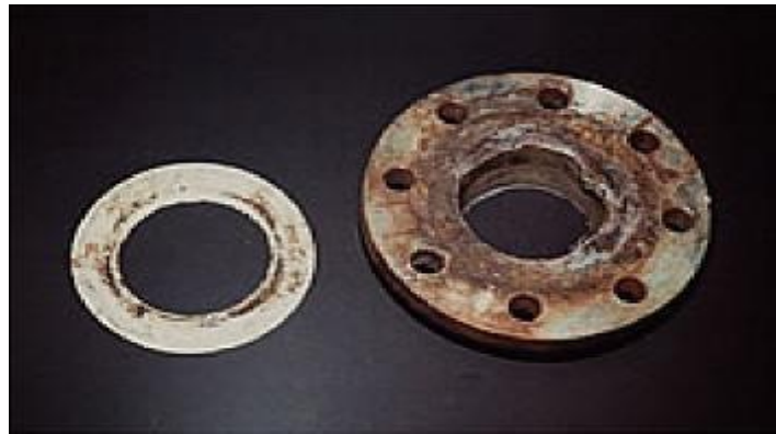
Figure I.4. Corrosion cavernuse d'un acier allié sous un joint [11].
