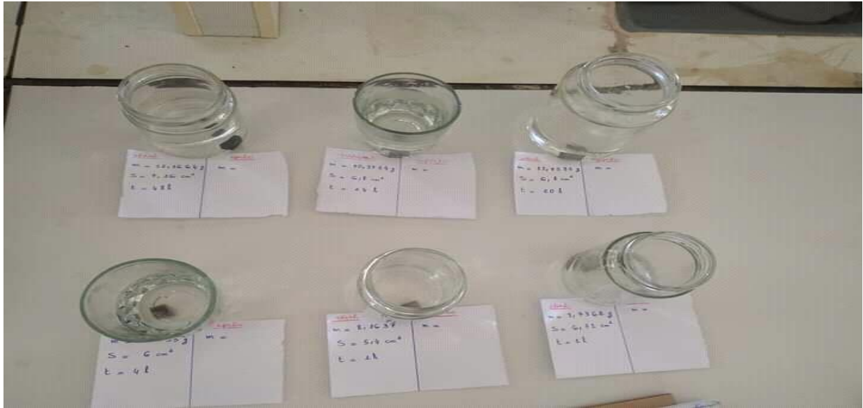
Figure II.3. L'acier X60 dans le milieu acide HCl sans l'inhibiteur.
