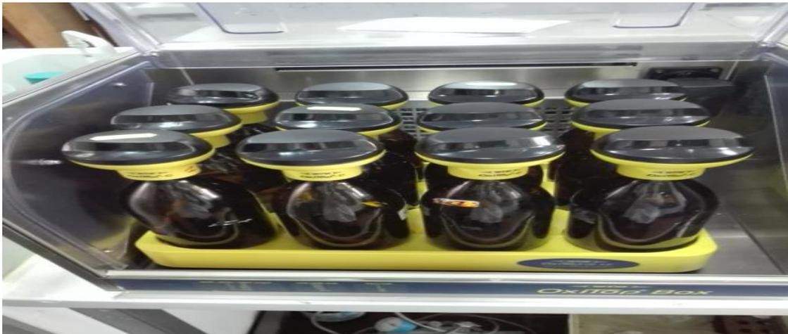
**Figure N°7: Un  $DBO_5$ -mètre**
