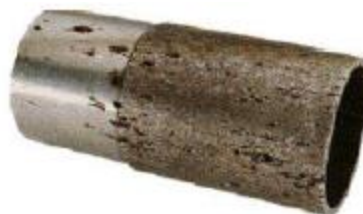
Figure I.6 : Corrosion par piqûres d'un acier inoxydable.
