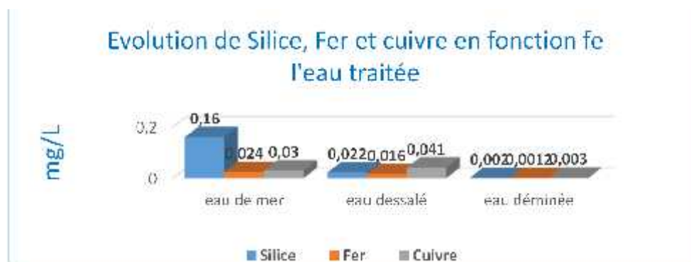
La figure .16 : l'évolution de fer, de cuivre et de la silice en fonction du l'eau traitée.
