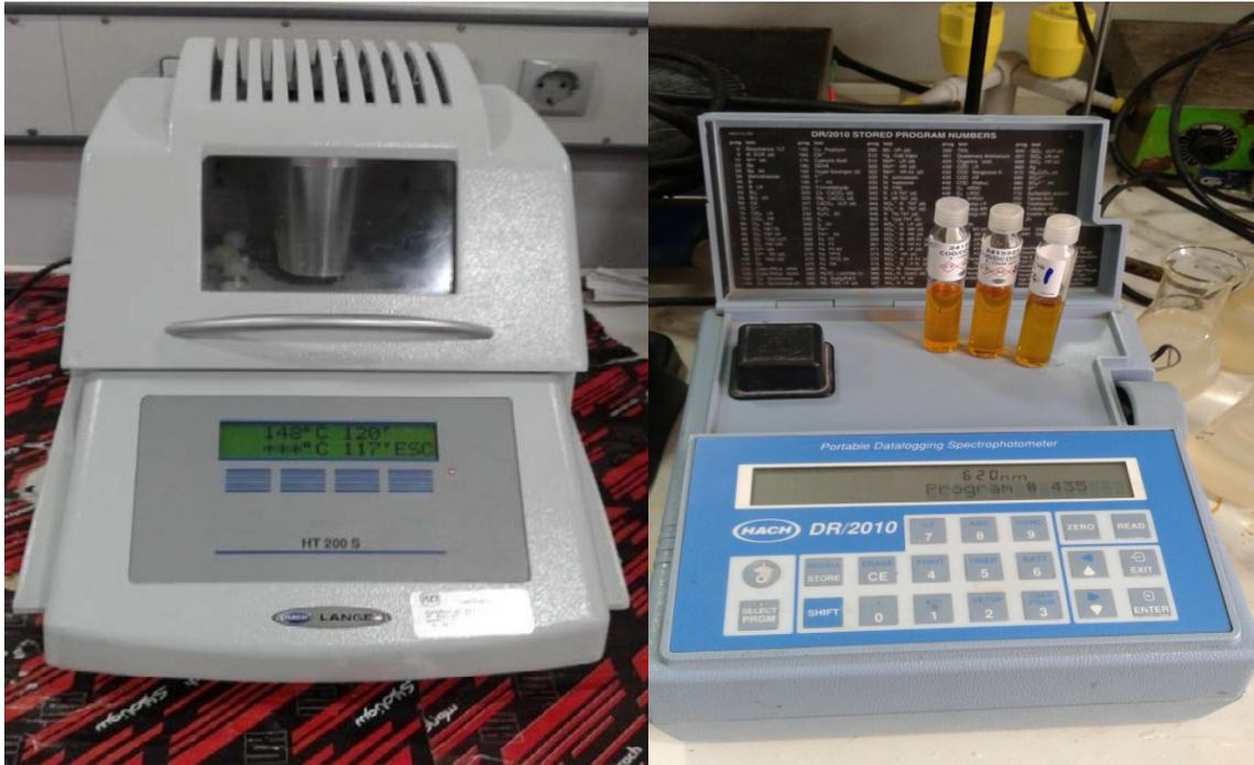
Réacteur HACH-Modèle (HT200 S).spectrophotomètre HACH DR/2010
