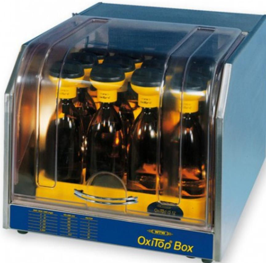
Dispositif pour mesurer la demande biochimique en oxygène.
