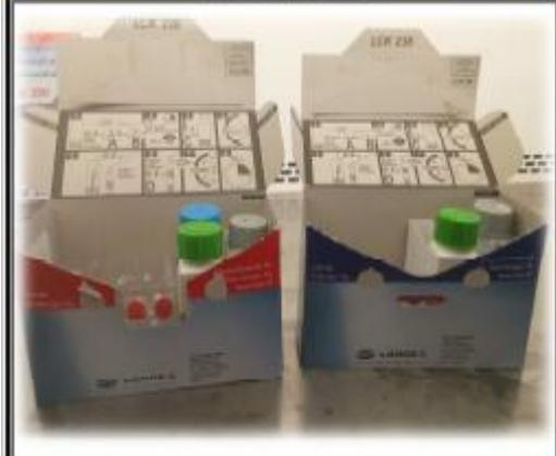
**Cuve d'analyse Azote total**
