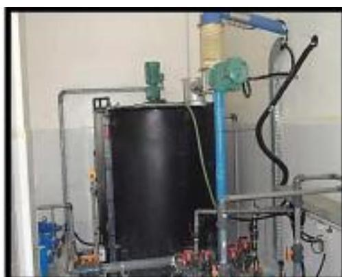
**Figure N° II.16 : La Cuve de préparation.**
