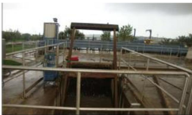
**Figure N° II.8: Le dégrilleur automatique.**
