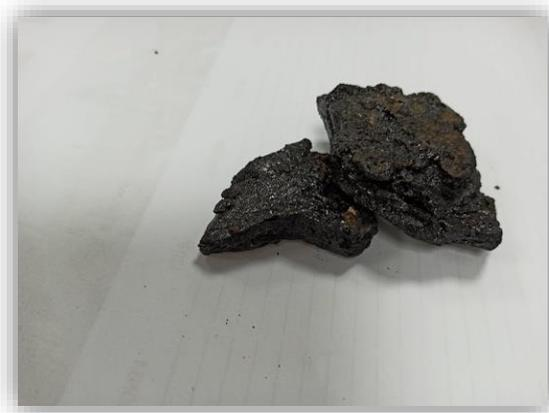
**Figure II-1** : Un échantillon du dépôt d'asphaltènes.
