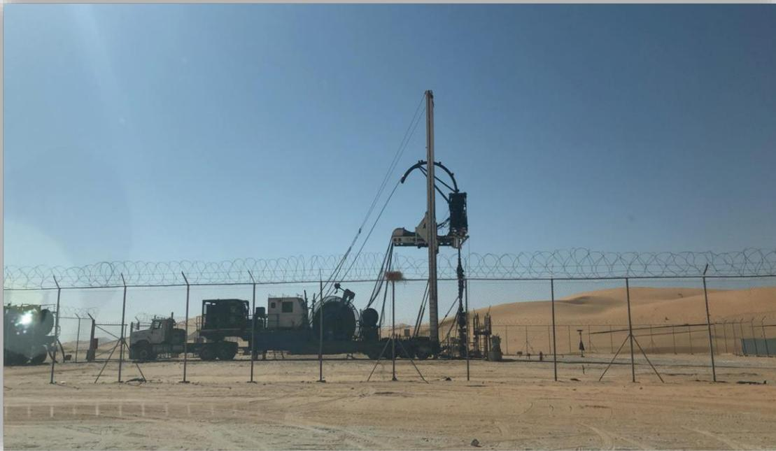
**Figure III-7 :** Traitement du dépôt d'asphaltène (Coiled tubing opération).
