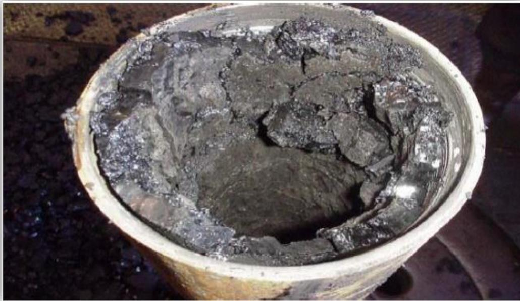
**Figure III-4 :** Déposition Asphaltènes (2007Petroskills LLC).
