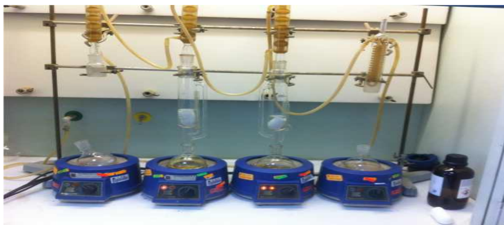
Figure III.3. Extraction par Soxhlet [17]
