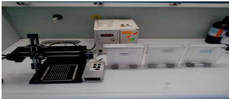
FigureIII.5. Les chromarodes et les cuvettes de TLC [16]
