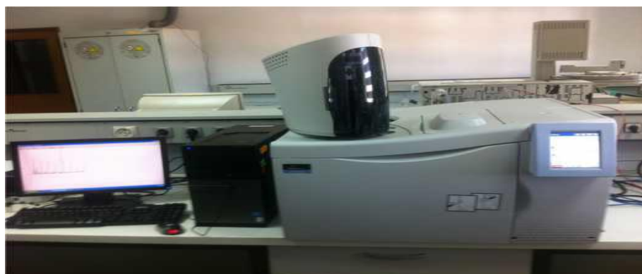
Figure III.6. Chromatographie en phase gazeuse sur colonne capillaire (Perkin Elmer Clarus 500) [8]
