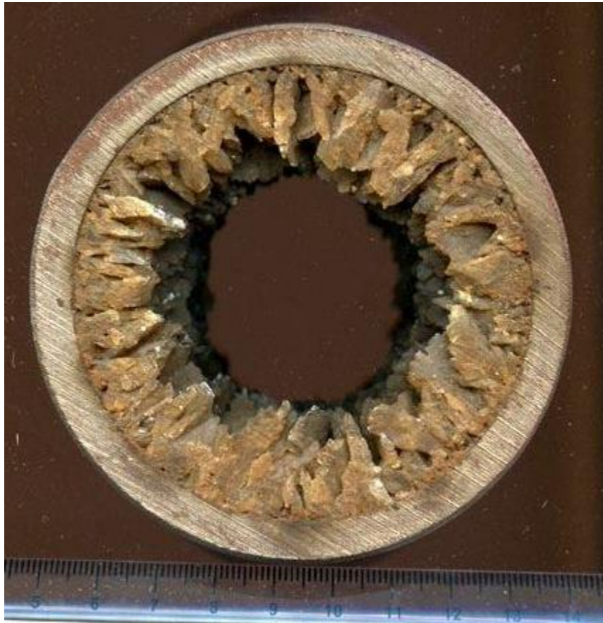
Figure II.2. Dépôts de \text{CaSO}_4 dans une pipe de pétrole [12].
