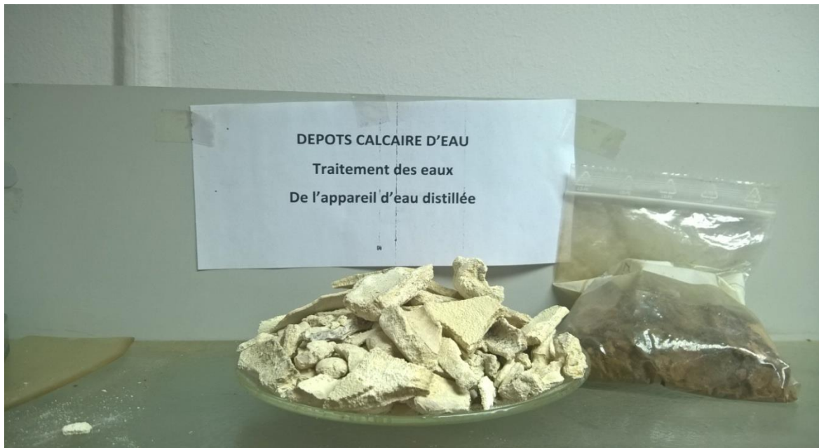
Figure A. Dépôt de calcaire d'eau proviens de l'appareil d'eau distillée
