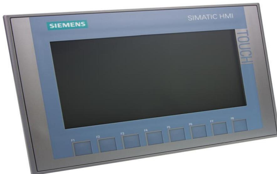
Figure IV.2 : L'interface de supervision KTP700 Basic
