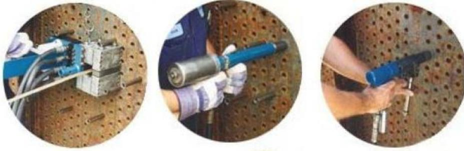
*Figure V.8 : nettoyage à l'aide d'un pistolet hydraulique*
