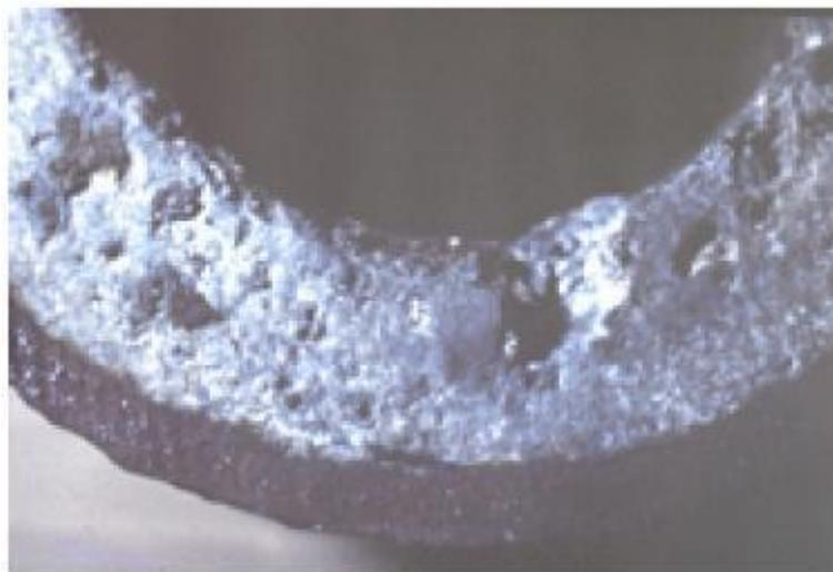
*Figure V.3 : Dépôt de forte épaisseur dans un tube de surchauffeur de Chaudière MP*
