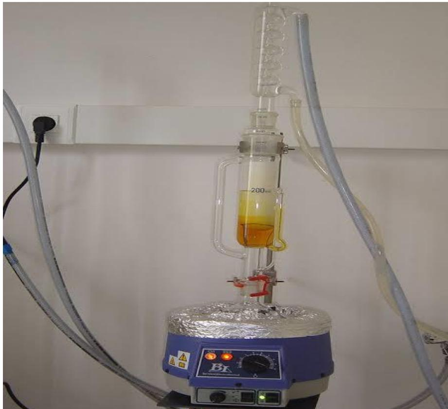
Figure III.4 : Extraction par Soxhlet.
