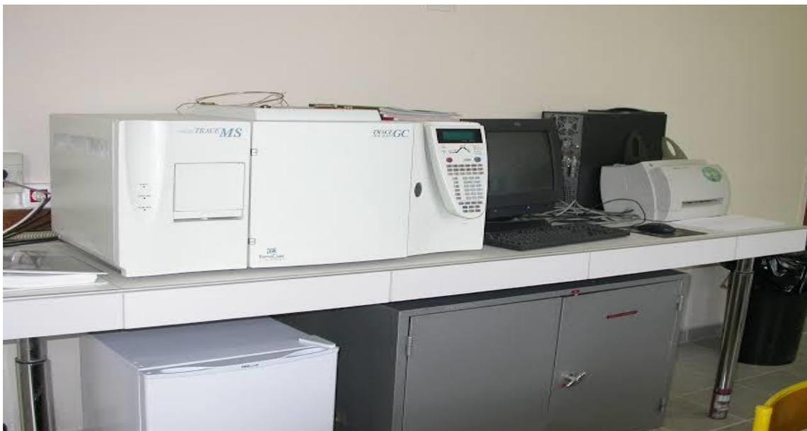
**Figure III.10 :** Chromatographie en phase gazeuse couplée à la spectrométrie de masse (GC/MS).
