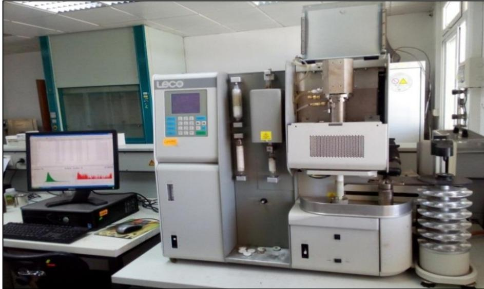
**Fig.III.1** : Doseur de carbone (LECO CS 230).
