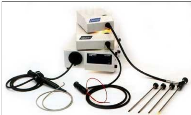
Fig.II.3 Endoscopes avec leurs sources de lumière
