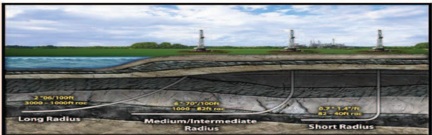
Figure 28 : Les courbures du puits horizontaux.
