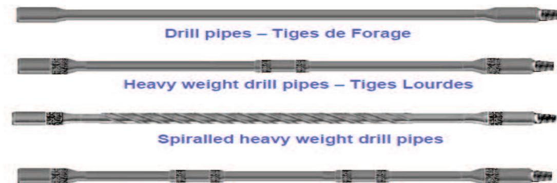
Figure 31 : Représentation des tiges de forage.
