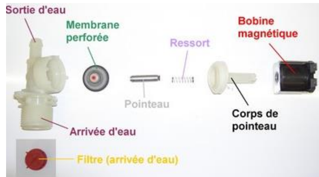
Figure III.23 : vue éclaté d'une électrovanne [21]
