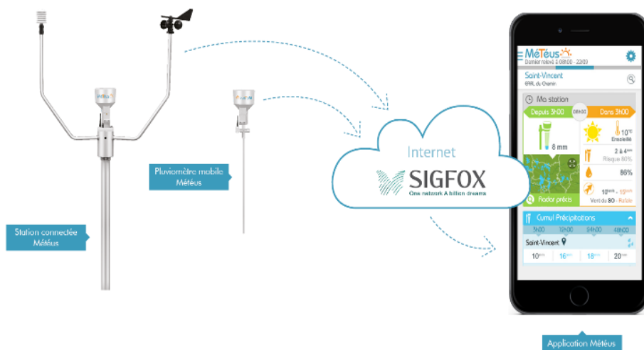
Figure II.8 : Exemple d'une station agricole connectée par sigfox [11]
