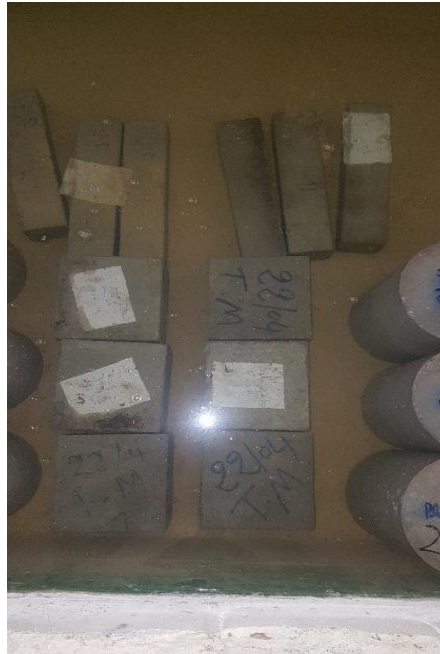
Figure. III.18. Conservation des éprouvettes dans un bac
