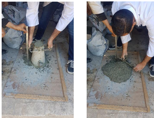
Figure. III. 19. L'essai d'affaissement au cône d'Abrams
