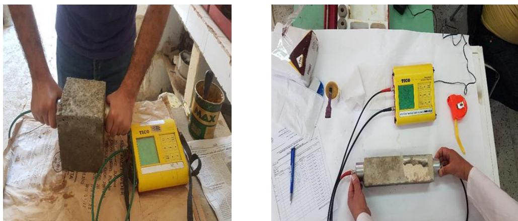
Figure. III. 20. Essais de propagation du son
