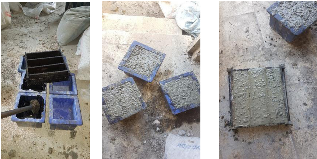
Figure. III.17. Confection des éprouvettes de béton
