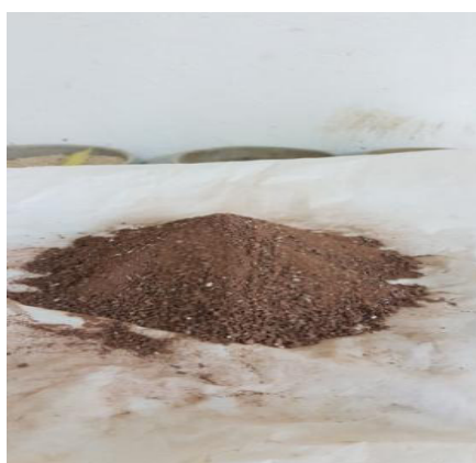
Figure.III.4. Déchet de faïence concassé en sable
