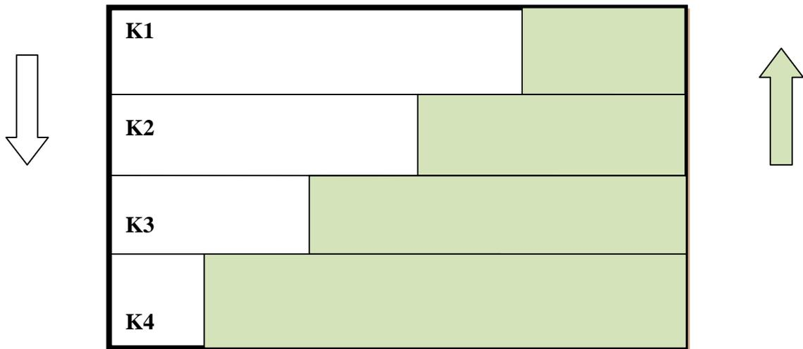
Fig.5. 1 : Ecoulement dans un réservoir stratifié (méthode de Stile).
