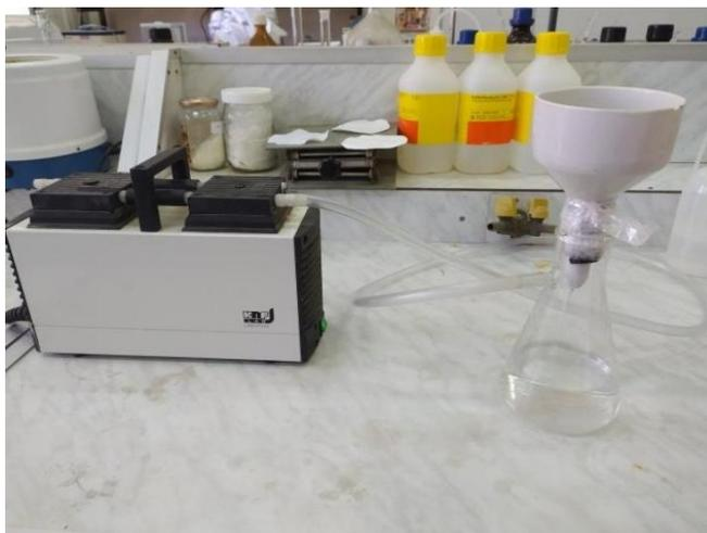
Figure 6: Rampe de filtration sous vide
